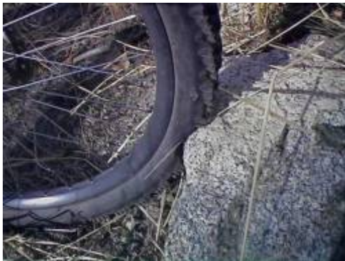
Pellizco de la cámara entre una roca y la llanta
